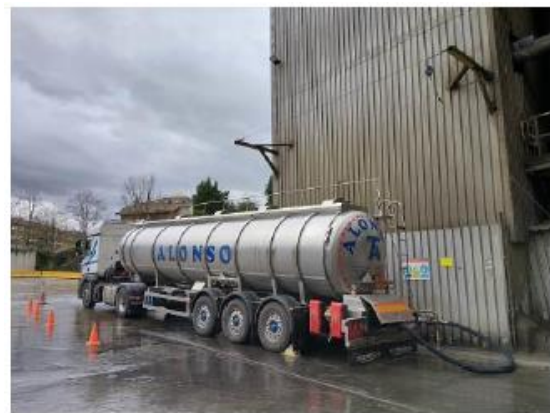
Camión con línea de vida para abrir bocas superiores. Calces colocados.
