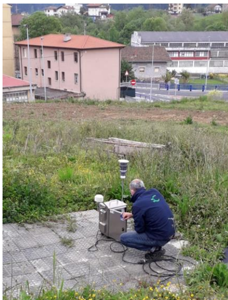
Instalando equipo de medición de partículas PM10.
