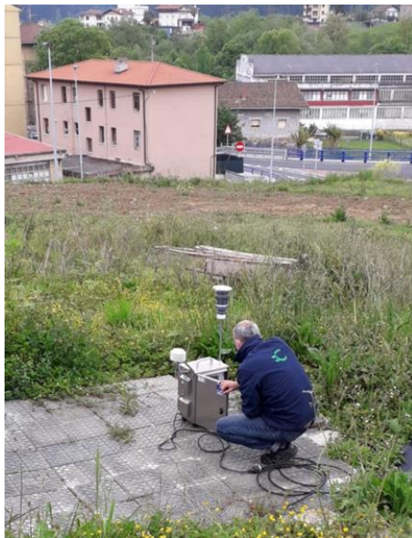
Instalando equipo de medición de partículas PM10.
