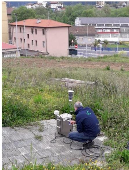
Instalando equipo de medición de partículas PM10.
