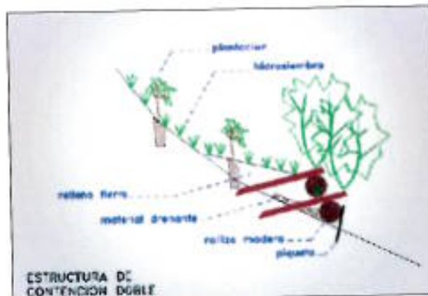
Fig 7. Aplicación de entramados tipo "Krainer" en la restauración de Peña Lemona.
