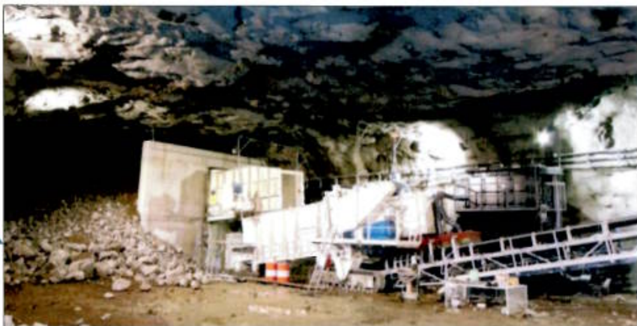
Fig 8- Alimentador blindado y machacadora horizontal en instalaciones de interior del sistema pozo-túnel.
