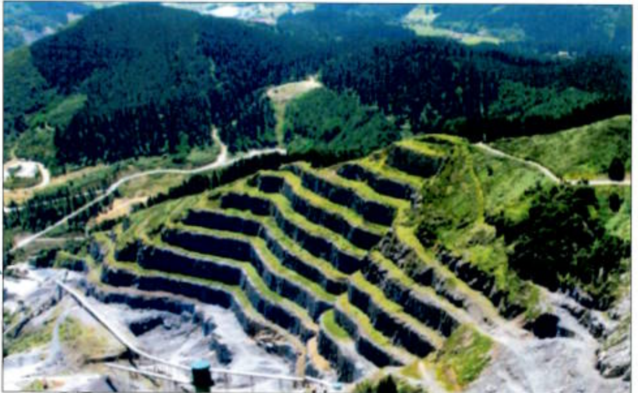
Fig 15- Visual general de las labores de explotación actuales ( inferior derecha) y bancos restaurados en la cantera de Apario. Explotación a cielo abierto.
